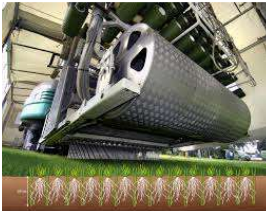
Rys. 16 Montaż trawy hybrydowej
