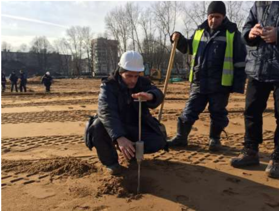
Rys. 5 Testowanie zwięzłości warstwy nośnej murawy
