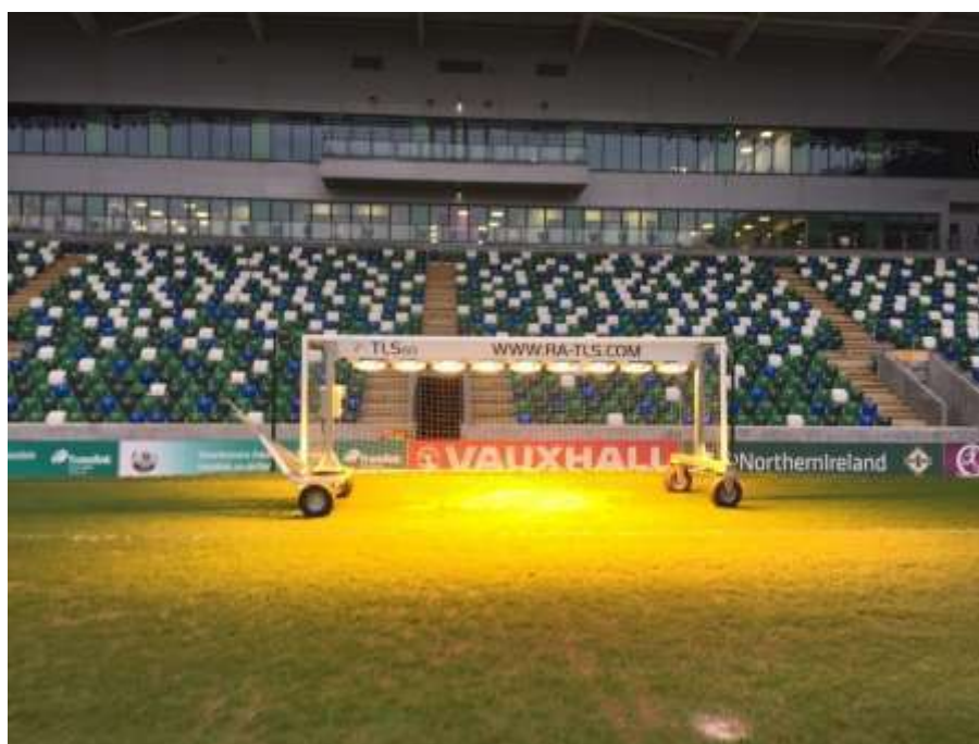
Rys. 33 Lampy do naświetlania murawy stosowane w celu zwalczania skutków zacienienia
