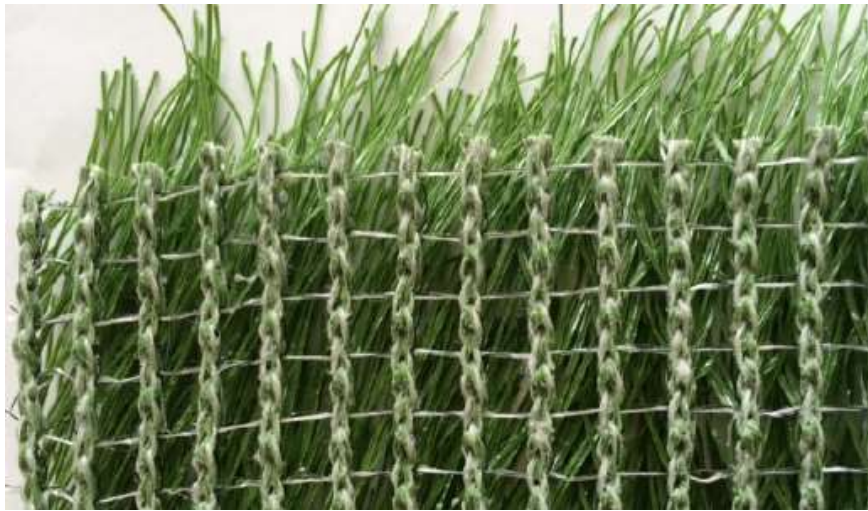
Rys. 18 System dywanowej murawy hybrydowej
