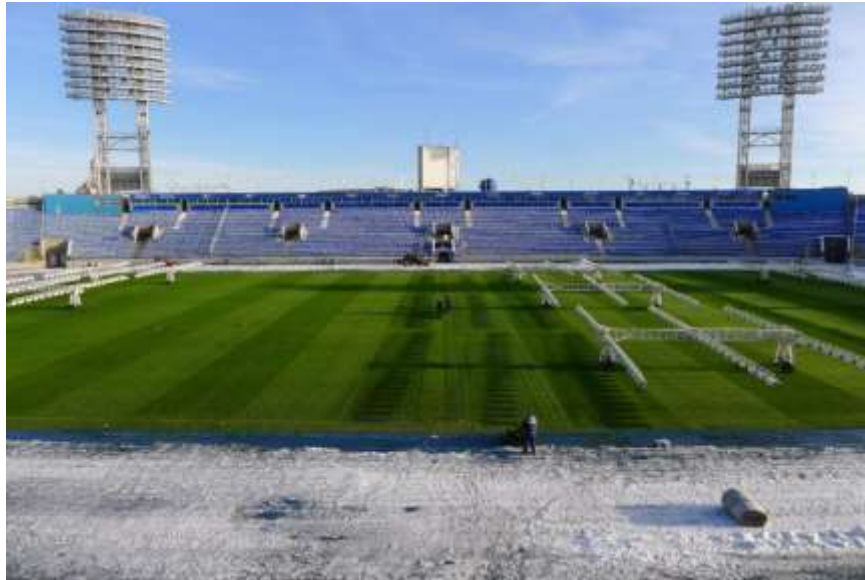
Rys. 34 Lampy do naświetlania murawy używane w celu regeneracji trawy w okresie wiosennym; ciepło wytwarzane przez lampy pozwala również na przywrócenie trawy do poprzedniego stanu
